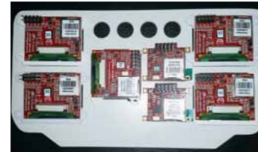
Ansicht von hinten mit den sechs in das Panel eingesetzten Displays. Die Fixierung erfolgt mit UHU Por
